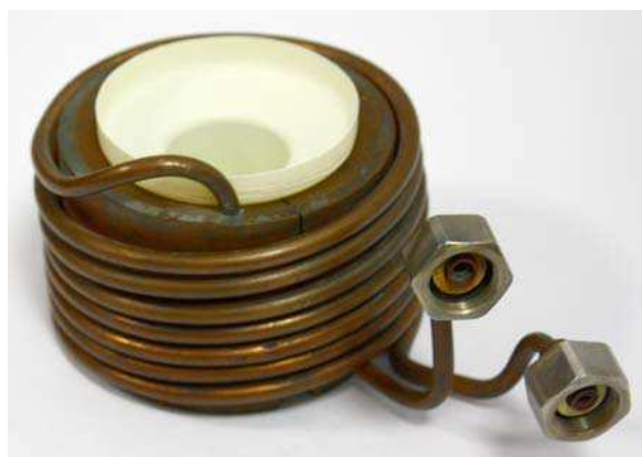
Рис. 4. Индуктор с тиглем для установки индукционного испарителя
