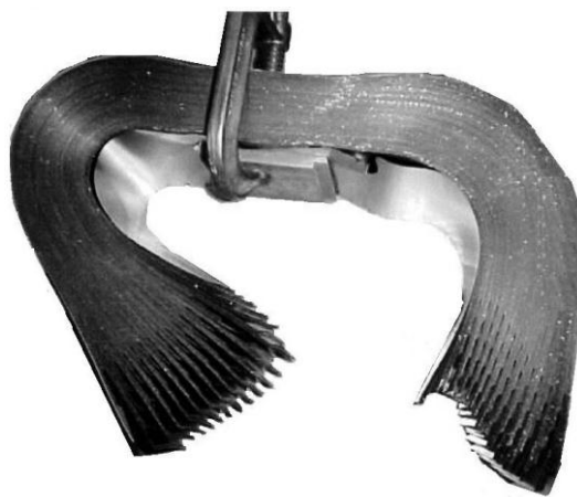
Рис. 6. Изготовление магнитопровода из аморфной ленты
