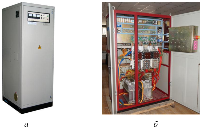
Рис. 2. Преобразователь частоты: а – тиристорный; б – транзисторный
