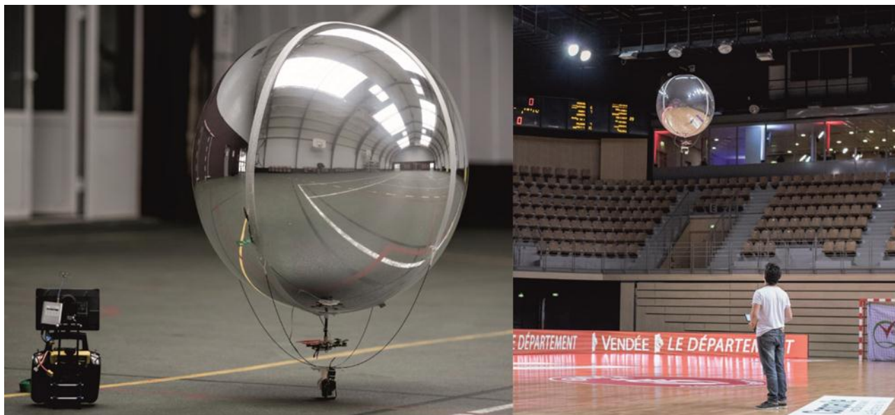
Рис. 2. Простейший БПЛА с аэростатической разгрузкой команды Horizon Vertical, компании Vendée
