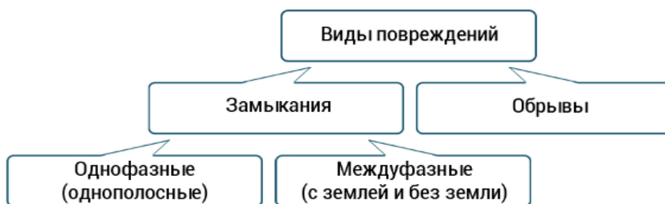
Рис. 1. Виды повреждений кабельных линий
