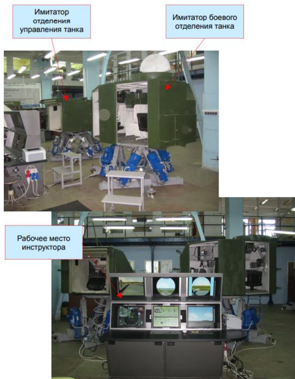
Рис. 1. Устройство комплексного тренажера экипажа танка Т-72Б
