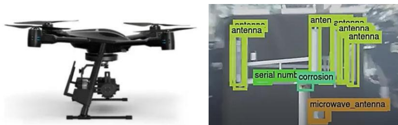
Рис. 2. Дрон Altura Zenith с машинным зрением и отображение результатов осмотра вышки
