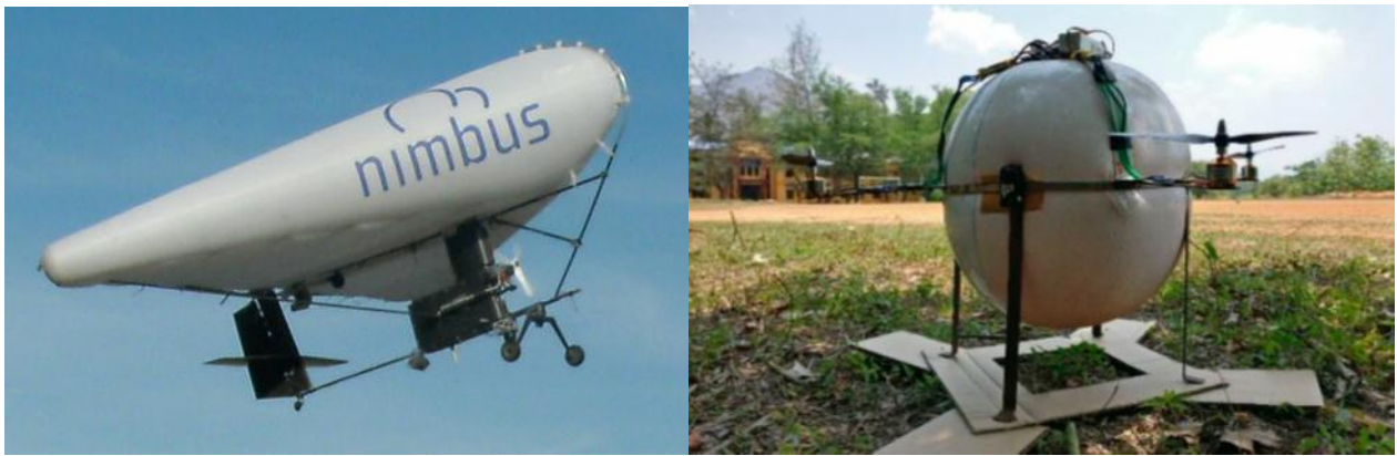
Рис. 3. Гибридные БПЛА: Nimbus EosXi – гибрид дельтаплана и дирижабля (слева) и дрон из NSS College of Engineering – гибрид квадрокоптера и дирижабля (справа)
