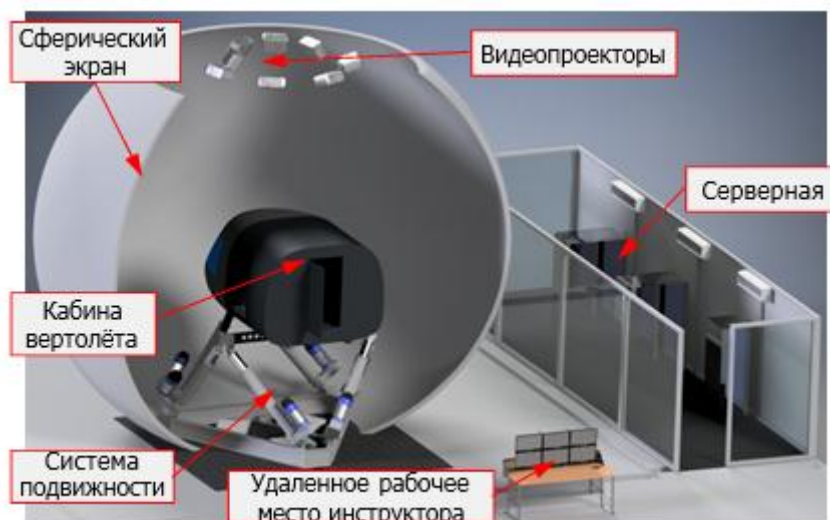
Рис. 2. Устройство комплексного тренажера экипажа вертолета Ми-17
