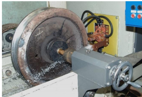
Рис. 1. Процесс заковки рабочей поверхности катка (колеса)
